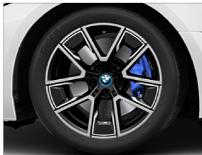
18 吋 M 空氣力學 858 M 型輪圈 / M 煞車套件 (藍色) 輪圈：8.5J X 18 / 9J X 18 輪胎：245 / 45 R18 255 / 45 R18
